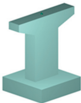
図-3 対象橋脚：単柱式 RC 橋脚
